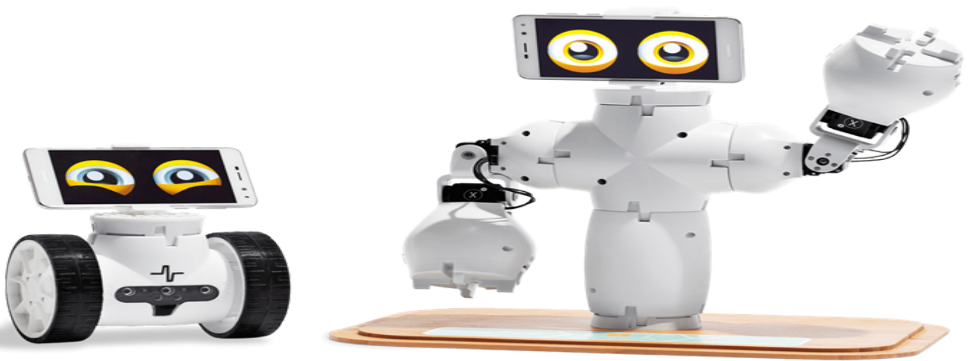
Fable-robotten (til venstre en robot med et hjulmodul og til højre en robot med to ledmoduler)
